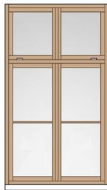
Δίφυλλο, ανοιγόμενο με ανακλινόμενο τμήμα στο πάνω μέρος
