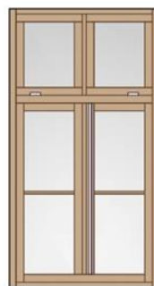
Δίφυλλο, ανοιγόμενο με ανακλινόμενο τμήμα στο πάνω μέρος
