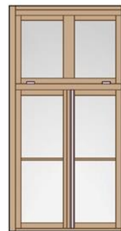
Δίφυλλο, ανοιγόμενο με ανακλινόμενο τμήμα στο πάνω μέρος
