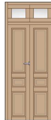
Δίφυλλη, ταμπλαδοτή θύρα με σταθερό τζαμιλίκι στο άνω μέρος (Αίθουσα διδασκαλίας)
