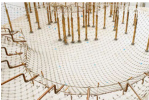
Εικ. 4.14: Το μοντέλο κρεμαστών αλυσίδων του Multifihalle.
