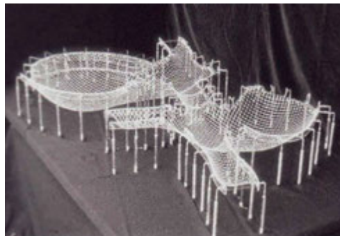
Εικ. 4.15: Το μοντέλο κρεμαστών αλυσίδων του Multihalle.
