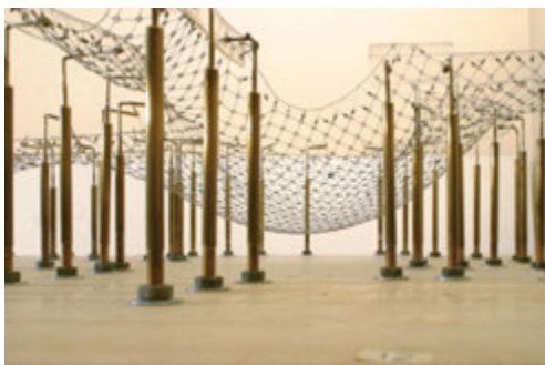
Εικ. 4.13: Το μοντέλο κρεμαστών αλυσίδων του Multifihalle.
