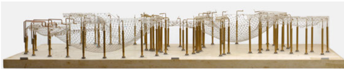
Εικ. 4.12: Το μοντέλο κρεμαστών αλυσίδων του Multifihalle.
