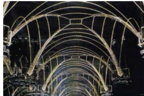
Εικ. 4.4: Σχηματισμός θολωτών μορφών με τη βοήθεια μοντέλου κρεμαστών αλυσίδων.
