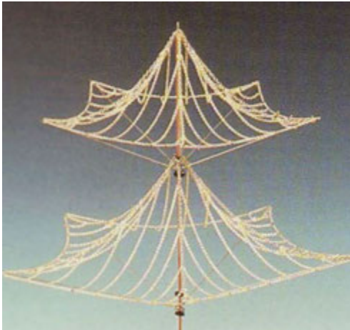
Εικ. 3.3: Διερευνητικό μοντέλο εύρεσης μορφής κρεμαστής οροφής χρησιμοποιώντας αλυσίδες σε σειρά.
