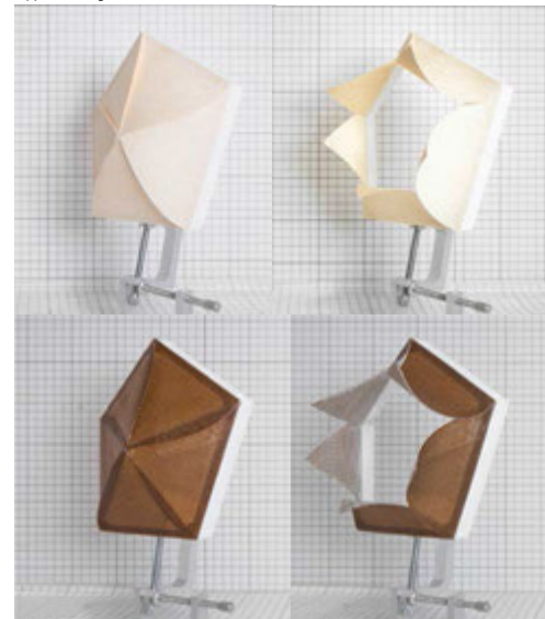
Εικ. 3.15: Κατασκευή τεχνητών υδροσκοπικών φύλλων χρησιμοποιώντας 3D-εκτυπωτή που μιμούνται απόλυτα τη συμπεριφορά των αντίστοιχων ξύλινων φύλλων.
