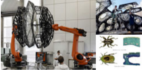
Εικ. 3.2: ICD/ITKE Research Pavilion 2013-14. Ελαφριά κατασκευή από fiberglass και ανθρακόνημα. Αποτελείται από αλληλένδετες κυψέλες που κατασκευάζονται από δυο ρομποτικούς βραχίονες. Η κατασκευή μιμείται την κυτταρική δομή του έλυτρου.
