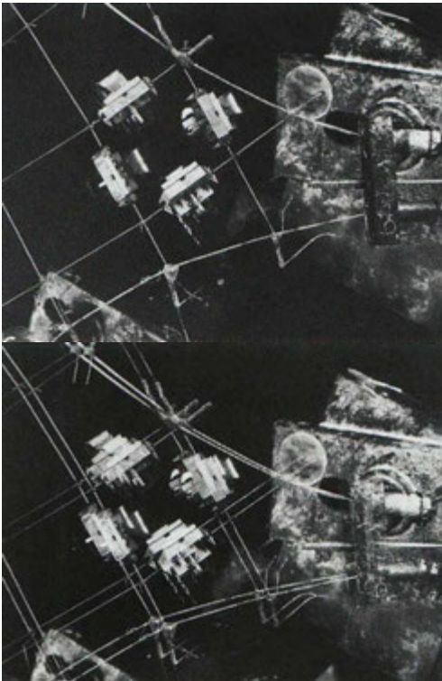
Εικ. 1.30: Φωτογραφίες απλής και διπλής έκθεσης αντίστοιχα που απεικονίζουν την παραμόρφωση του μοντέλου υπολογισμού δυνάμεων όταν σε αυτό ασκούνται φορτία
